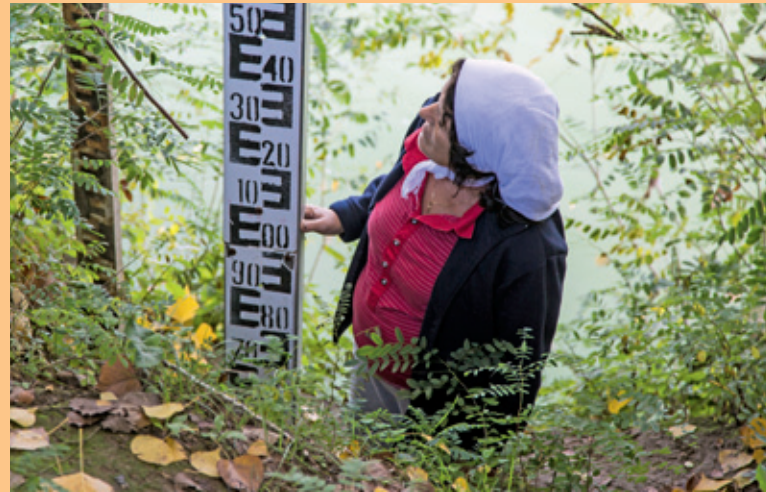
Die Bevölkerung in den Überschwemmungsgebieten ist auf genaue und schnelle Informationen angewiesen, zum Beispiel über kritische Pegelstände, die automatisch oder manuell erfasst werden.
